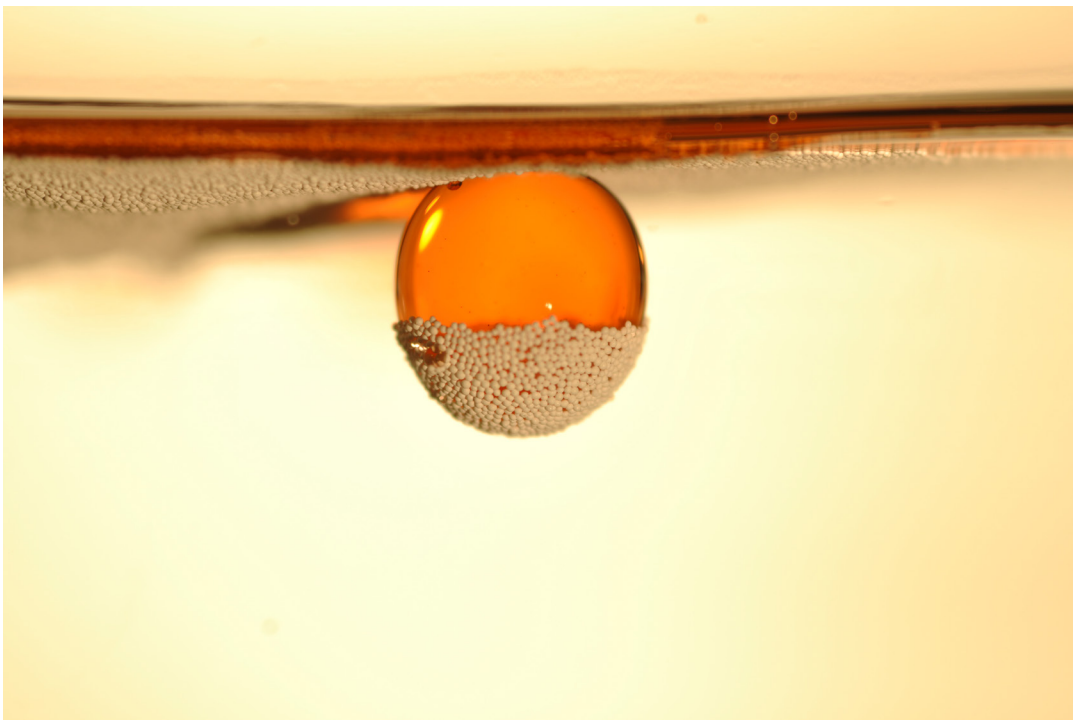
Goutte d'huile silicone dans de l'eau avec une coque partielle de particules d'oxyde de zirconium. © Manouk ABKARIAN/Suzie PROTIERE/CNRS Photothèque
